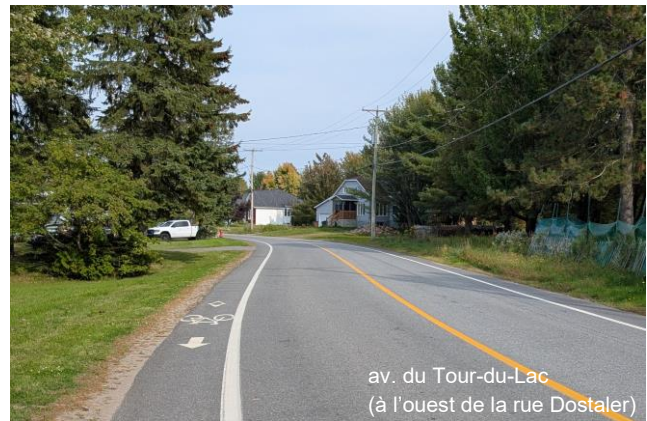
Figure 2.41 Bande cyclable de largeur insuffisante
