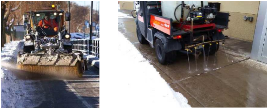
Figure 4.22 Appareils d'entretien hivernal des voies cyclables et des trottoirs
