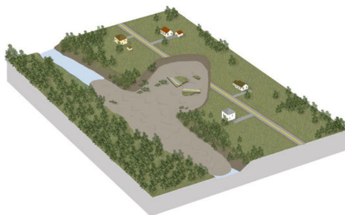
Figure 10 | Glissement fortement rétrogressif
