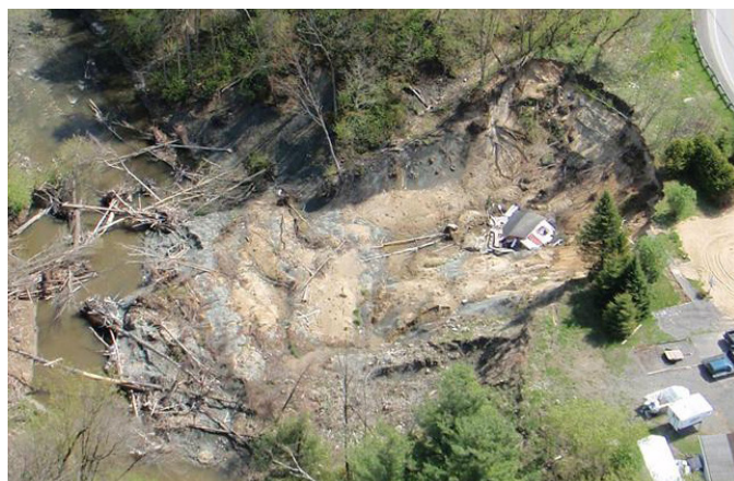
Figure 9 | Exemple de glissement rotationnel
